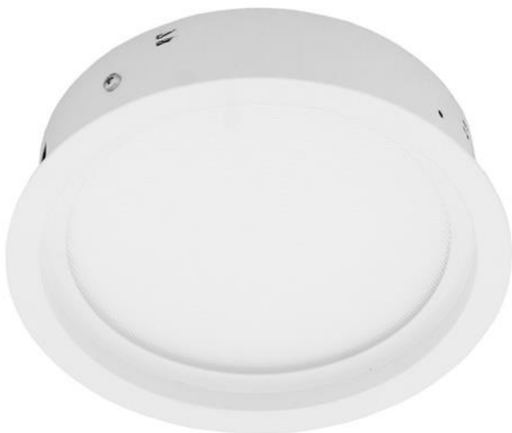
G1 - LED SVÍTIDLO 12W, ZAPUŠTĚNÉ DO PODHLEDU, IP 54, D210 mm
